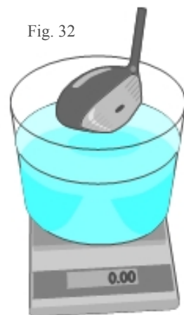
Fig. 32 Peso digital (puesto a cero) con un contenedor lleno de agua y cabeza lista para ser sumergida.
