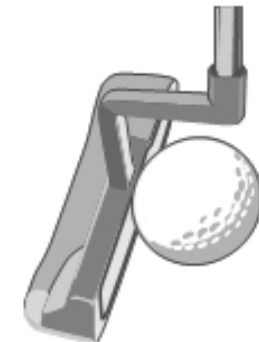
(f) Si la varilla o el cuello de un putter están sujetos a la cabeza en el centro de la cara, no deben sobresalir por delante de ésta más de 0,84 pulgadas (21 mm) -el radio de una bola-. El cuello de este putter se extiende hacia adelante más de la mitad de la bola (no “sencillo”, no conforme).
